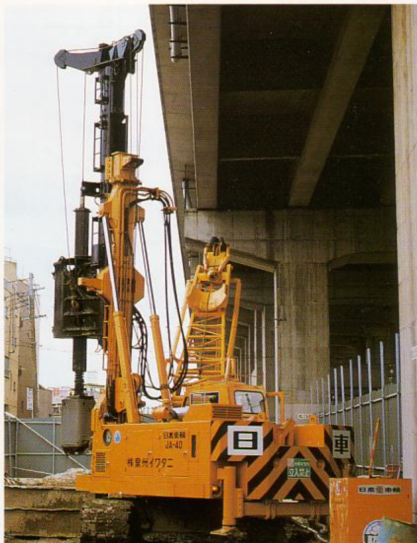
写真は、最大掘削深さ8m（ステムロッド付…14m）仕様です。
