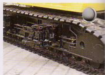
▲クローラ伸縮作業時
