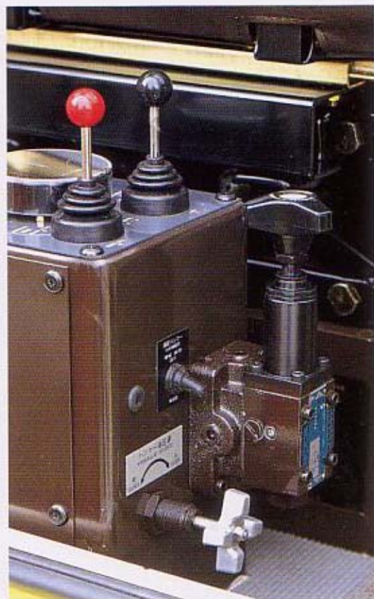
▲微速コントロール装置
