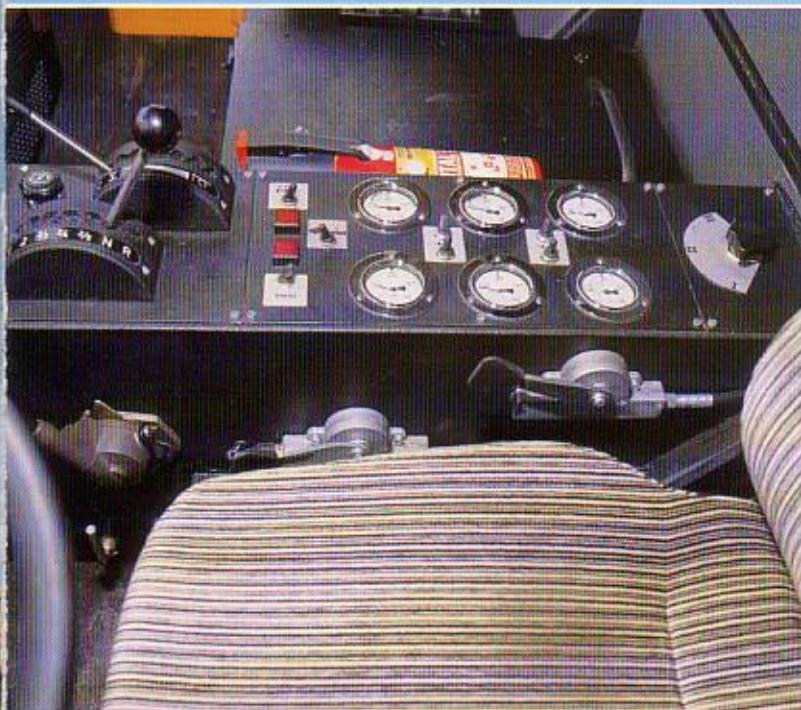
“ハイドロニューマチック・サスペンション”システムは、運転室から電気式リモートコントロールによって調節でき、3つの走行モードに合わせることが可能です。
