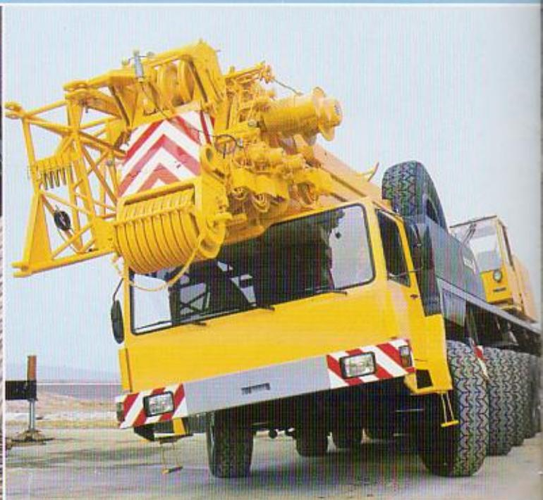
本システムは手動リモコンで簡単にクレーンを片側に傾けたり、最高30cmの上げ下げができます。この多能なシステムは、オフロード走行時、天井の低い建物に入る時、頭上スペースが制限されている時などに真価を発揮します。
