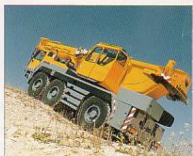
全機種軸重を12トンに設定。抜群の登坂能力での走行性能を確保し、場所を選びません。
