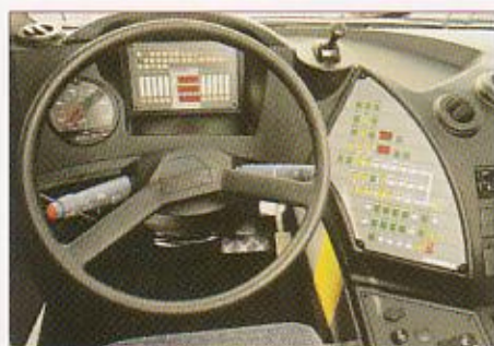
シャーシ運転席の操作パネルは、飛行機のcockピットを思わせるデザインで、見やすいデジタル表示。
