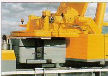
カウンターウェイトは、クレーンキャビン内より取付・取り外し操作が可能。
