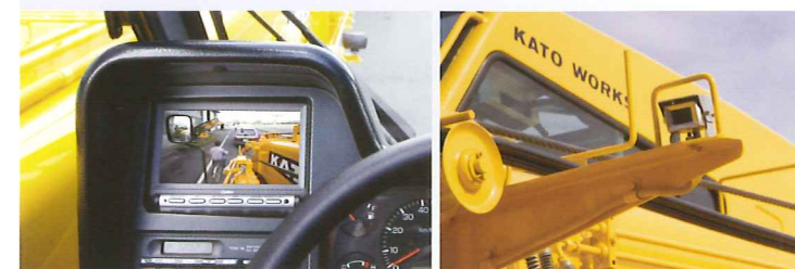
左前方確認カメラが、車体左前方をモニター表示。(写真はハメコミ合成画像です)
