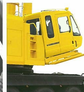
▲15°までのチルト式。スライド式ステップの採用でキャブへの乗り込みが楽になりました。
