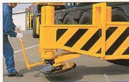
●持ち運び不要、車幅内に納まる格納式アウトリガフロート
