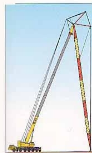
●ヘビーリフトジブの立組
