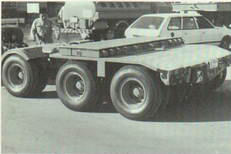
3軸20輪低床ポールトレーラ 荷台高 1000mm (タイヤサイズ 825×16×14P R)
