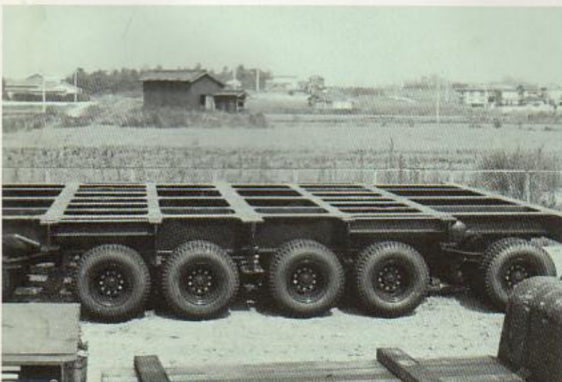
6軸72輪分割式ドーリー(400ト積) (油圧式操向遠隔操作方式)
